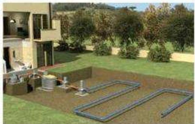
Per il dimensionamento, si rimanda alle Norme DIN Tedesche che, in modo assai semplificato, indicano per ogni abitante servito una lunghezza minima di trincea di dispersione, data dalla tabella seguente:
